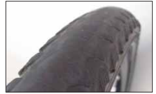
Profil ist weg. Gummi ist noch vorhanden. Den Reifen kann man noch fahren.
