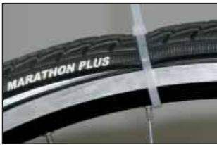
Ein Kabelbinder als helfende dritte Hand.
