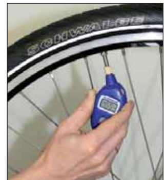
Luftdruckprüfung mit dem Airmax Pro.
