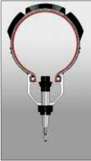
Tubeless-System: Reifen und Felge dichten direkt miteinander ab.
